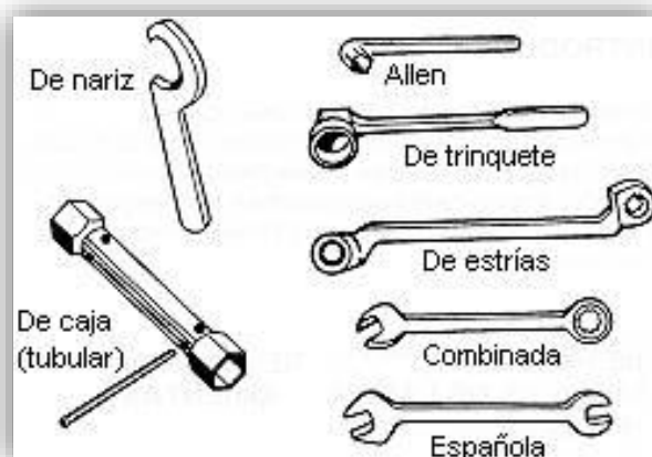
Fig. 6: Tipos de llaves de boca fija
