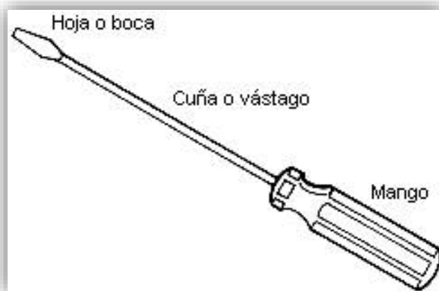
Fig. 3: partes de un destornillador
