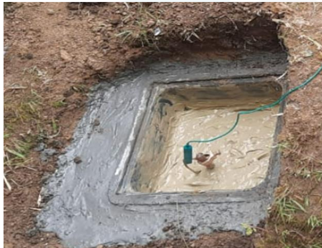
Ilustración 5 Marco de Cemento SPT
